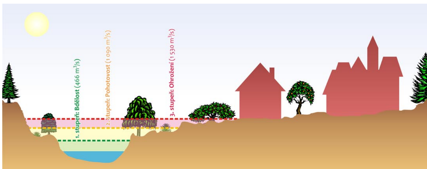
Běžný průtok ve Vltavě je kolem 100 m 3 za sekundu. Povodňové stupně – bdělost, pohotovost a ohrožení (případně extrémní ohrožení) – jsou vyhlášovány v závislosti na zvyšování průtoků. Obrázek obsahuje mezní hranice průtoků ve Vltavě pro měrnou stanicí Praha-Chuchle.
