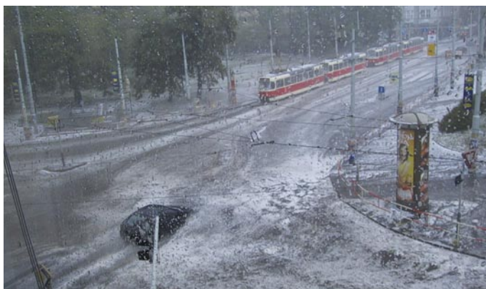
Zatopení křižovatky Karlovo náměstí – Ječná při přívalové srážce v červnu 2005. Překročení návrhové kapacity uličních vpustí způsobuje lokální zatopení ulic a částečně i přilehlých objektů. Zdroj: MF Dnes, 2005
