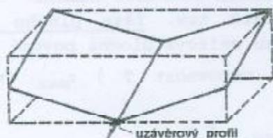
Obr.4.158. Povodí ve tvaru otevřené knihy
