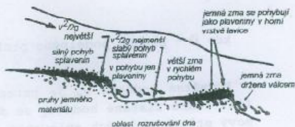
Obr.4.206. Pohyb splavenin po dně vytvořeném z dun
